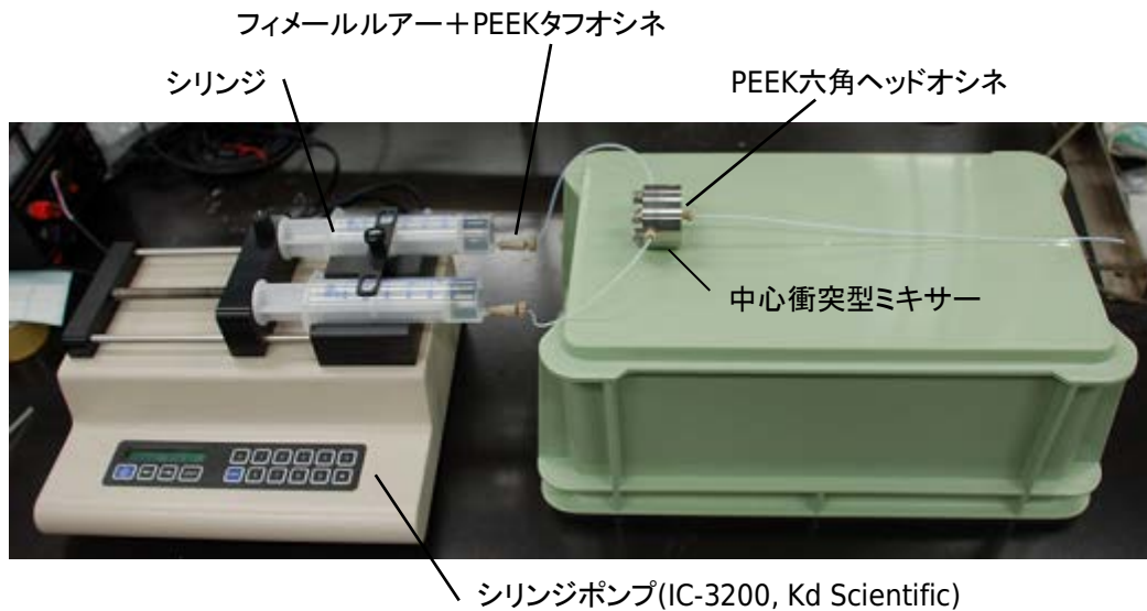
(a) シリンジポンプ (IC-3200, Kd Scientific), PEEK フィッティング, 中心衝突型ミキサーを用いる場合
