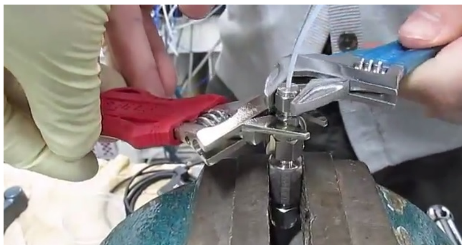
図 6 万力で固定してレデュースーを締め付ける例
